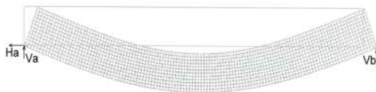
Рис. 1.1 Балка однопролетная. Конечно-элементная модель
