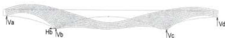
Рис.1.3 Балка трехпролетная переменного сечения. Конечно-элементная модель
